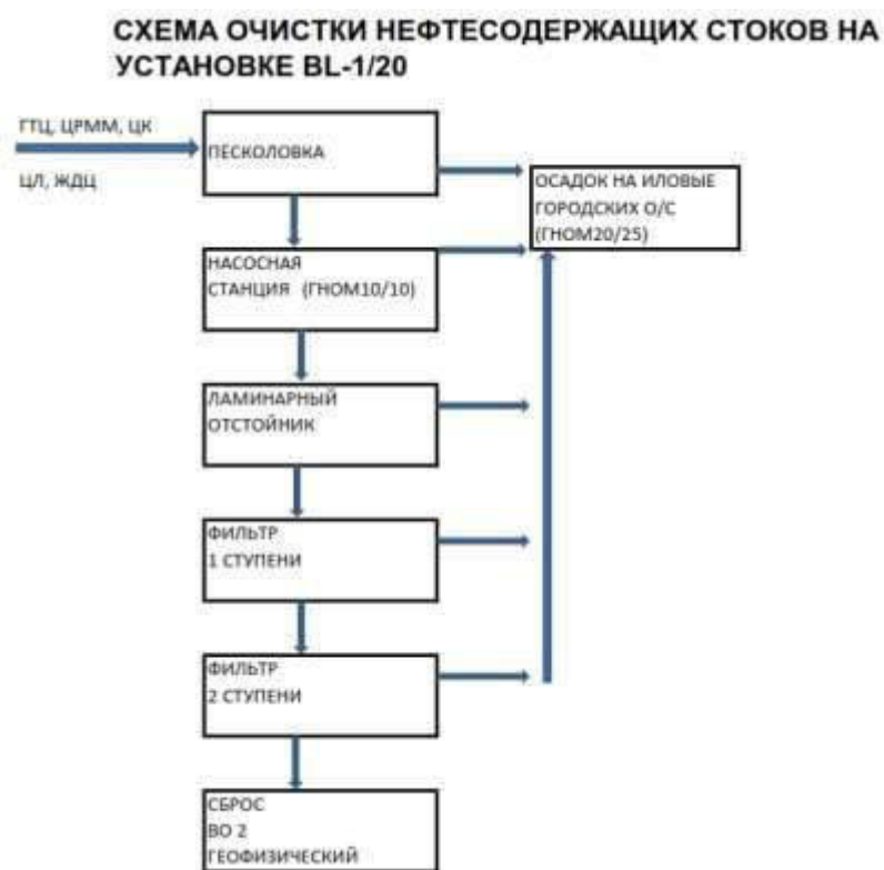
Рисунок 2.2 Технологическая схема очистки производственных сточных вод Центральной площадки
