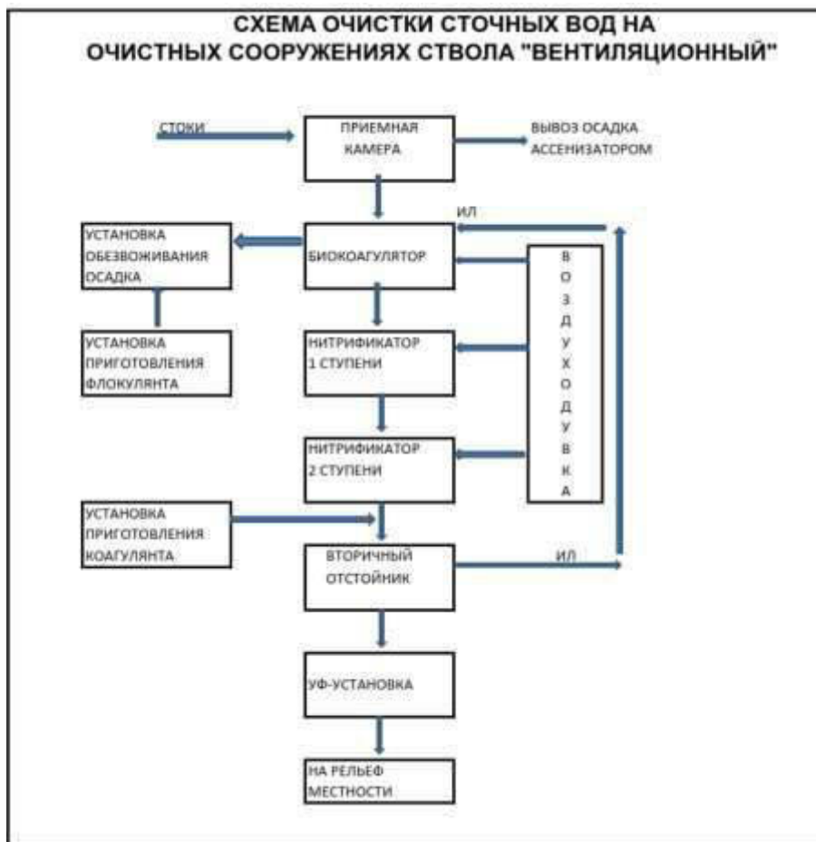
Рисунок 2.5 Технологическая схема очистки бытовых сточных вод ШДНК
