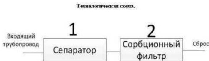
Рисунок 2.8 Технологическая схема очистки дождевых сточных вод ШДНК
